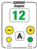
Detectar el valor de la corriente en amperios en la placa del motor de la bomba. Pulsar el botón **A** (led verde encendido) y configurar el valor en la pantalla con los botones **+** y **-** (paso 0,5 A). Una vez configurado el valor, pulsar el botón **A** (led amarillo encendido) para confirmar la regulación. Cuando la bomba funciona, en la pantalla aparece el valor real de la absorción del motor.
