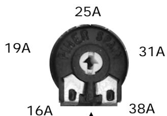
Regular la corriente de protección del motor en un valor superior al 10-20% de la corriente nominal, EJEMPLO: para un motor con absorción nominal de 30A, regular en alrededor de 36A
