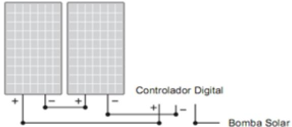
**2 paneles solares de 550 W****ESPECIFICACIONES DE LOS PANELES SOLARES RECOMENDADAS**
