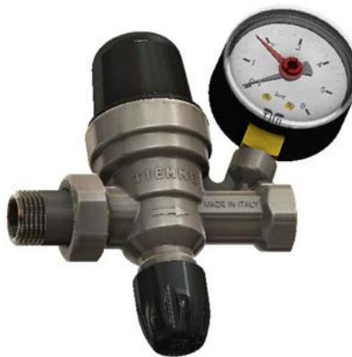
La válvula de llenado Art. 3160GN se utiliza para efectuar en automático la carga y la reintegración del agua en la instalación de calefacción con circuito cerrado; permite también regular la presión en el circuito. La válvula de llenado está equipada con válvula de retención que impide las posibles inversiones del flujo.
