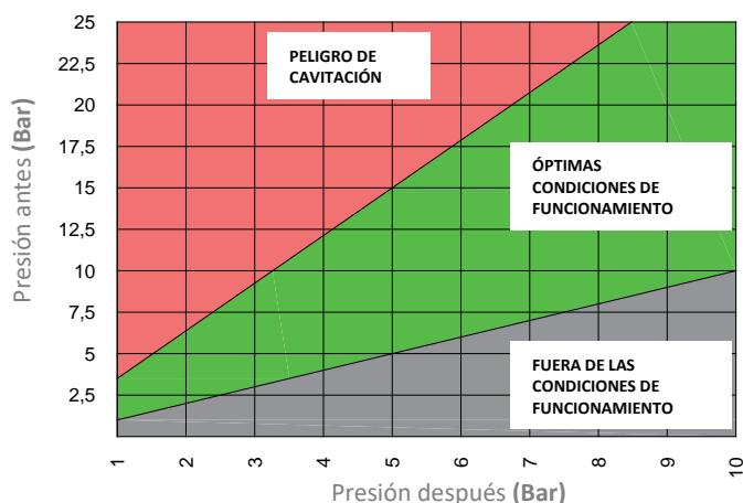
Cuando la relación entre la presión antes y la presión después supera el valor 3:1 se produce un funcionamiento en cavitación del componente, por lo tanto, es necesario prever dos reductores de presión instalados uno después del otro, para llevar a cabo una REDUCCIÓN DE PRIMER NIVEL y sucesivamente una REDUCCIÓN DE SEGUNDO NIVEL.
