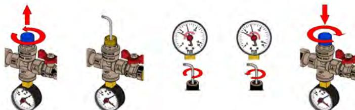
Nota. Girando en sentido horario la presión de salida aumenta, girando en sentido antihorario la presión de salida se reduce.
