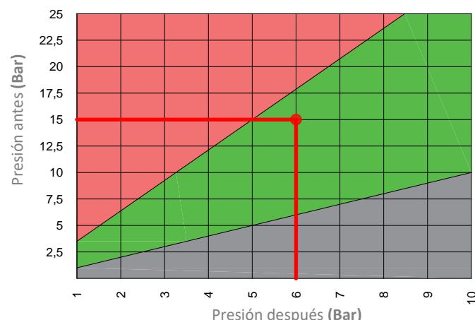
Con el segundo reductor la presión se reducirá de 6 bar a 3 bar, con la relación óptima 6:3 = 2 (REDUCCIÓN DE SEGUNDO NIVEL).
